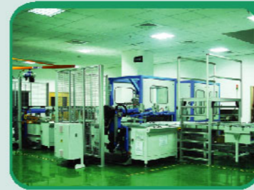
多層板真空壓合 積層板真空熱圧着ライン Laminator
